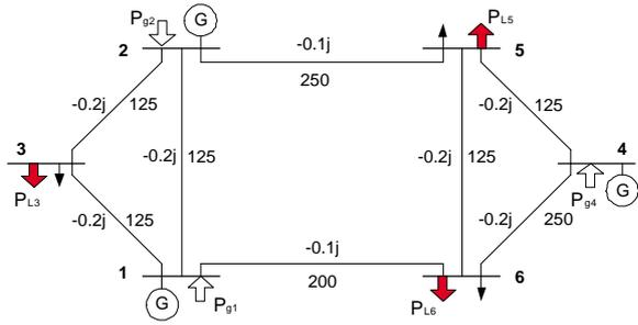
Fig. 1. A 6-Bus Test System.
